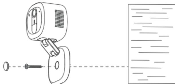
■ 天井に設置(3Mテープはねじ込み前に位置を固定するために使用することができます。)
