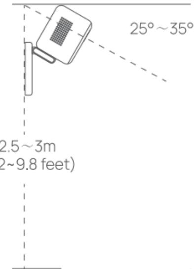
Auf einer gemauerten Oberfläche (3M-Klebeband kann zur Fixierung der Position vor dem Eindrehen der Schrauben verwendet werden)
