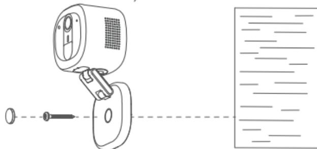
■ Installation an der Decke (3M-Klebeband kann verwendet werden, um die Position zu fixieren, bevor die Schrauben eingeschlagen werden)
