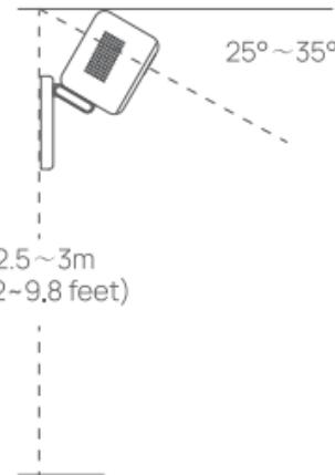
石造りの表面(3Mテープで位置を固定してからネジを打ち込むことができます。)
